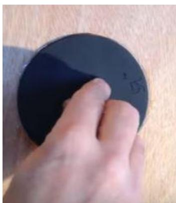
c) そのまま Rev-Loc を押し付けた状態で、しばらくテープ留にして接着剤を乾燥させます。接着剤が乾燥したら SSP6 を Rev-Loc に取付けます。
