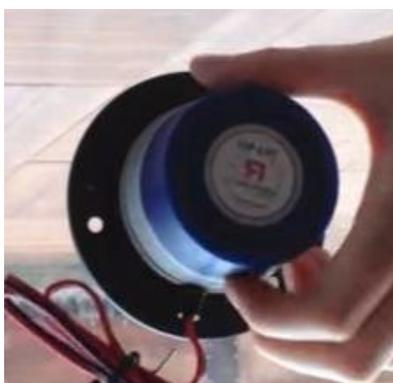
e) Rev-Loc を接着するガラス面等の表面に強く押し付けます。その際に先ほどつけた、スピーカーケーブルの印が真下に来るように注意して押し付けて下さい。
