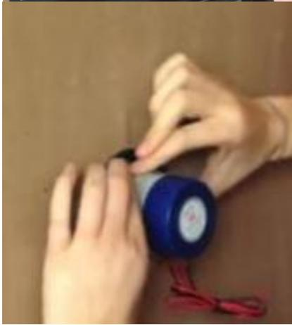
b) その後すぐに接着場所に Rev-Loc の底を強く押し付
