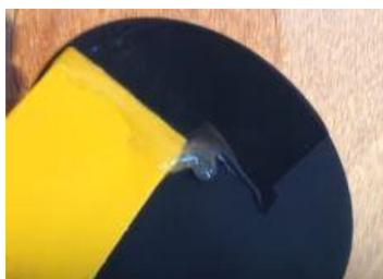
b) Rev-Loc をしっかりと接着箇所に押し付け、余分な接着剤を伸ばすように Rev-Loc を左右に僅かに回して、Rev-Loc からみ出た接着剤をよく拭き取ります。
