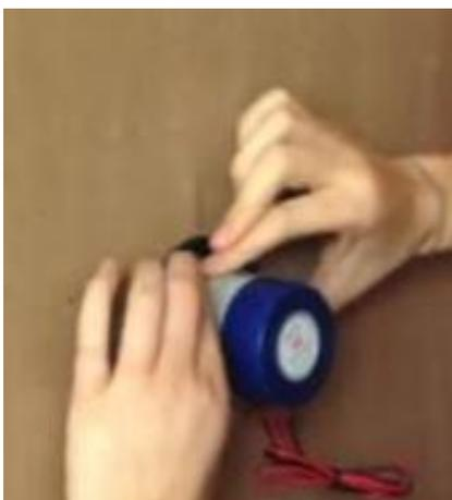
b) その後すぐに接着場所に Rev-Loc の底を強く押し付けます。その際に接着箇所には埃や汚れが付着していないかをよく確認して下さい。接着剤が効き始めるまで、30 秒程度押し付けたままにして下さい。もし空間に余裕があれば、最初に Rev-Loc を接着し、その後に SSP6 を取付けて下さい。
