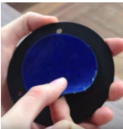
a) Rev-Loc の接着面を拭いて、きれいに乾いていることを確認してから Rev-Loc の真ん中に UHB テープを貼ります。
