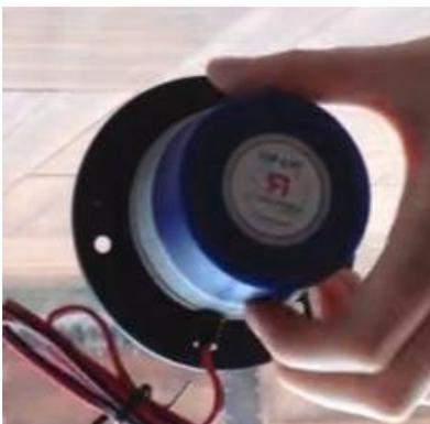
e) Rev-Loc を接着するガラス面等の表面に強く押し付けます。その際に先ほどつけた、スピーカーケーブルの印が真下に来るように注意して押し付けて下さい。
