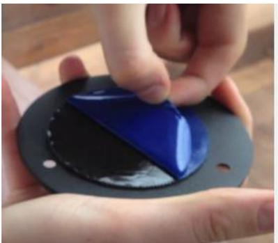
d) Rev-Loc に貼りつけた両面テープの反対側（ガラス面などへの接着側）の保護フィルムを剥きます。
